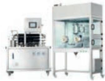
Este equipo realiza tratamiento a altas temperaturas y se utiliza para la esterilización de alimentos que contienen niveles bajos de acidez (pH menor a 4,6), consiste en calentar el producto a más de 130 °C, durante un periodo muy corto, para después pasar por un proceso de enfriamiento y envasar el producto dentro de la misma línea a temperatura ambiente. Este proceso destruye todos los microorganismos, lo que hace que el
